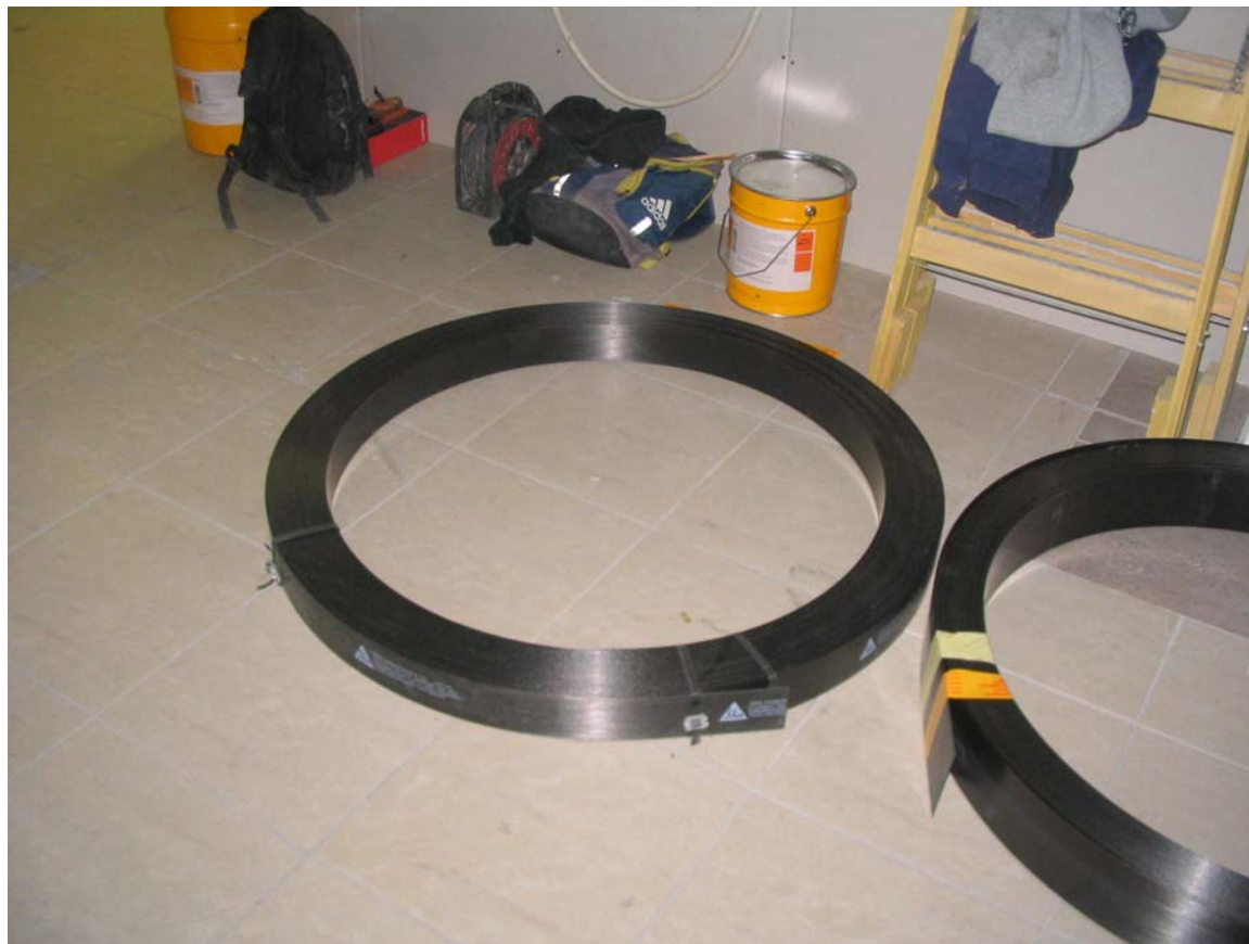
MOM Park - alkalmazott szénszálak lamella tekercsben
